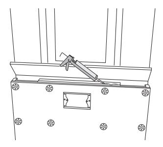
**3)** Nach Zuschnitt wird die Deckplatte mit einem geeigneten Montagekleber (z.B. JACKODUR® Montagekleber, BOARD-FIX®) aufgeklebt.
