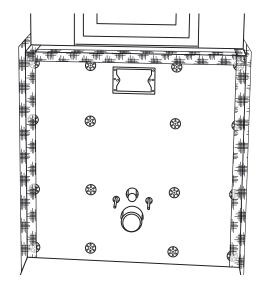
**4)** Alle Kanten werden mit einem geeigneten Armierband (z.B. JACKOBOARD® Armierband) verspachtelt.
