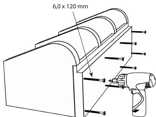
5) Die Stützwände A werden angeschraubt.
