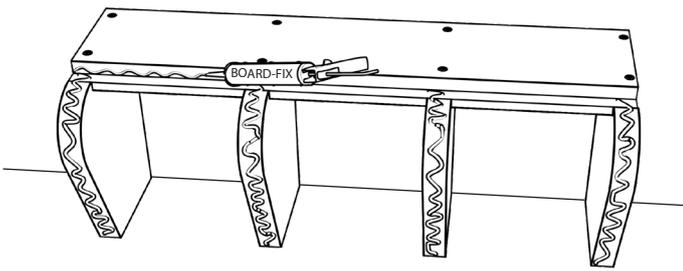
7) Auf den Stützwänden A und an der Längsseite der Abdeckung B1 wird BOARD-FIX® aufgetragen.
