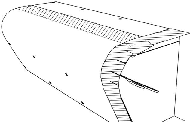
**13)** Alle Stoßfugen und sichtbaren Stirnkanten werden mit dem selbstklebenden JACKOBOARD® Armierband abgeklebt. Bei den Rundungen wird das Armierband mit der Schere eingeschnitten und überlappend angeklebt.
