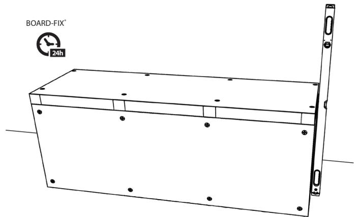
10) Die Sitzbank wird an Wand und Boden angeklebt, so dass sie lotrecht positioniert ist.
