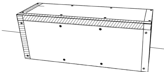
11) Alle Stoßfugen und sichtbaren Stirnkanten werden mit dem selbstklebenden JACKBOARD® Armierband abgeklebt.
