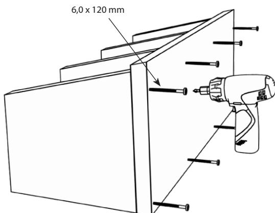
5) Die Stützwände A werden angeschraubt.
