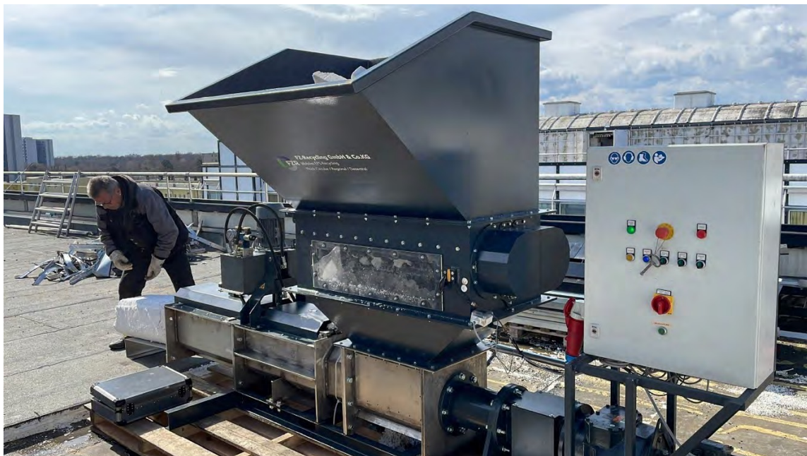
Abbildung 6A. Verdichtung für das Recycling (Quelle: IVH, EUMEPS, NEPSA und EPS-Branchen).
