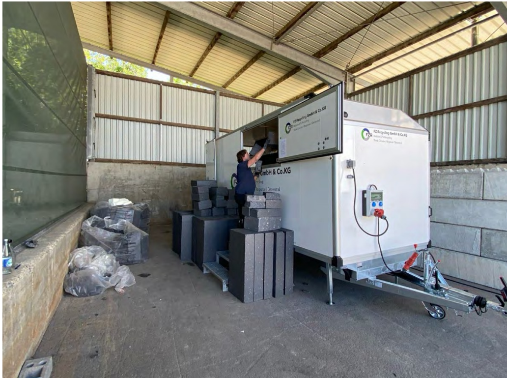
Abbildung 5. Mobiler EPS-Verdichter im Einsatz (Quelle: IVH, EUMEPS, NEPSA und EPS-Branchen).
