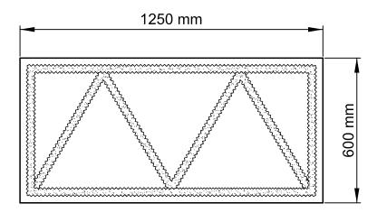
► **Verdübelung** mit Fassadendübel (Tellerdurchmesser 60 mm), 4 Dübel pro Platte (0,75 m²), Anordnung der Dübel >15 cm über Geländeoberkante (wegen Bauwerksabdichtung)
